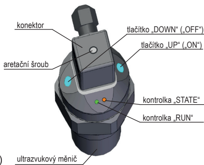
Obr. 30: Hlavní části měřicího zařízení (verze s tlačítky)
